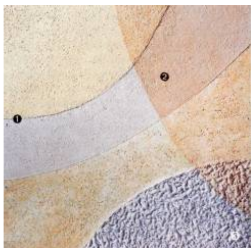
Илл. 1. Виды силикатных покрытий на обработанной флуатом и прогрунтованной белой силикатной краской штукатурной основе: 1 покрывное; 2 лазурное (лессирующее); 3 структурное покрытие с наполнителем из кварцевого мела
